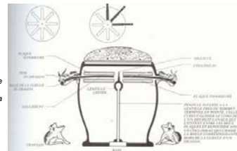
Reconstit. du sismographe de Zhang Hen (II ème s) L'onde sismique provoquait la chute d'une balle dans la gueule d'un des crapauds, indiquant sa direction
