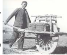
brouette traditionnelle, charge au-dessus de l'axe
